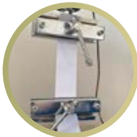
Teste de força de tensionamento
