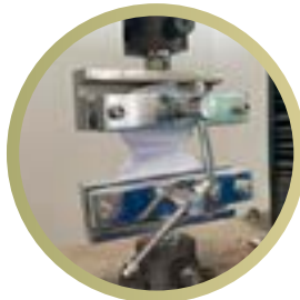
Teste de força de rasgo
